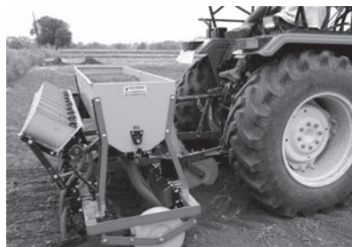
Fig. 3 FYM applicator cum planter in actual use
